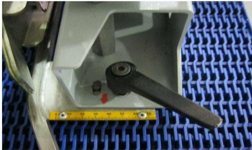
**Figura 5.14** Ejemplo de Centerline, control visual en Case Packer. Guía Inferior de Botellas, Entrada Derecha.
