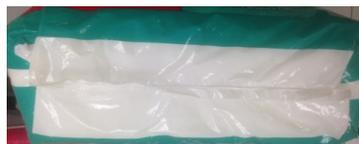
Figura 4.4: Área sin impresión del panel inferior del pañal. Esta zona fue modificada en los planos mecánicos para flexibilizar el rango de sello y disminuir la holgura de la bolsa.
