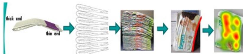
Figura 4. 3 Simulación de arrugas del empaque Pampers: En la imagen de la izquierda, dice final grueso (nariz del producto) y final delgado (apertura del producto). Esta simulación refleja como la forma del producto se traduce en una pila de pañales no uniforme que genera un pañal con mayores niveles de estrés y arrugas (siendo el mayor nivel de arrugas el que está sombreado en rojo). (Figuera, 2016).
