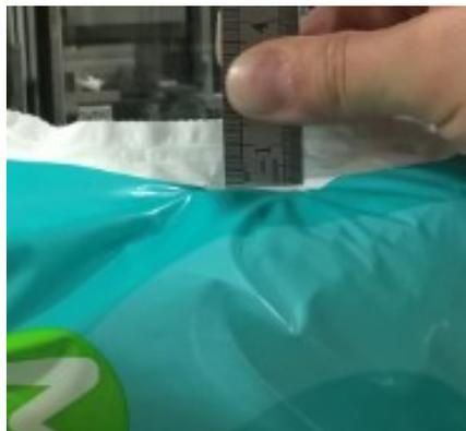
Figura 3.1 Método utilizado para medir holgura de la bolsa (absoluta).
