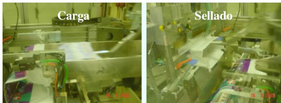
Figura 2.10: En la imagen de la izquierda se puede observar el proceso de llenado del empaque con la pila de pañales comprimida. En la imagen de la derecha, se puede observar el proceso de sellado del empaque lleno (De Abreu, 2014).
