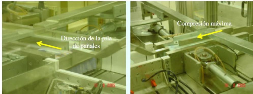
Figura 2.9: En la imagen de la izquierda se indica la dirección a la que queda la pila de pañales en el proceso. En la imagen de la derecha se observa la compresión principal, en donde la pila alcanza su valor máximo de compresión (De Abreu 2014).
