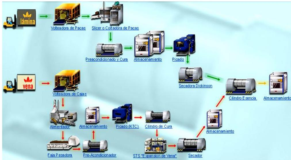
**Figura 3.2.** Diagrama del procesamiento de tabaco en el Departamento de Manufactura Primario.
