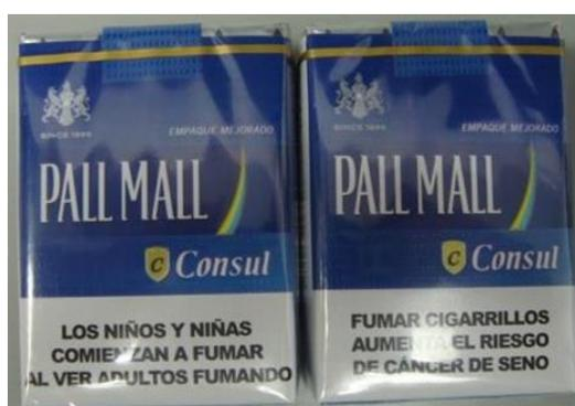
En la parte superior de las cajetillas, se notan rugosidades causadas por un mal sellado. Al compararlas con las cajetillas de control, las cuales no presentan algún defecto que altere la imagen del producto, se puede concluir que se debe mejorar el sellado con Teleplastic en futuras utilizaciones del material.
