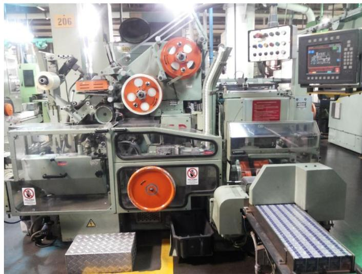
**Figura 3.5.** Máquina Encelofanadora - Empaquetadora, encargada del recubrimiento de las cajetillas de cigarrillos.
