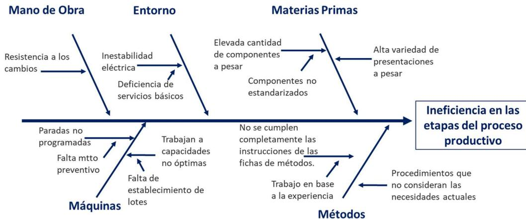
Figura 3.4 Diagrama Causa-Efecto de la ineficiencia en las etapas del proceso productivo.
